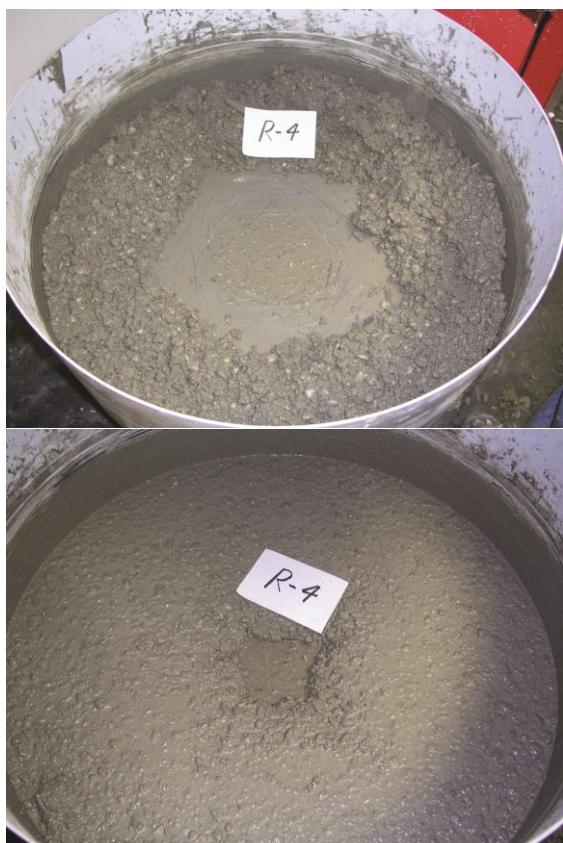
Slika 3. Mješavina betona prije i nakon dodavanja aditiva
