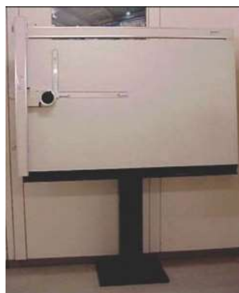
Slika 1 Crtaća daska s kliznim vodilicama
