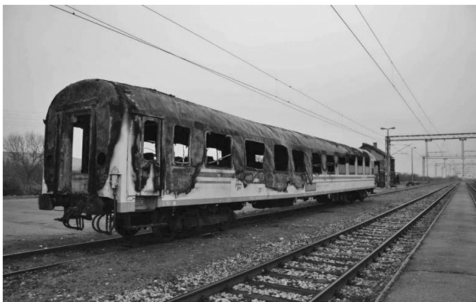
Slika 14: Požar putničkog vagona ( http://www.forenzika.hr/973.aspx )
