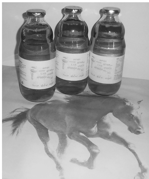
Slika 3 Etiketa u bliskom infracrvenom (1000 nm) spektru na staklenim bocama
