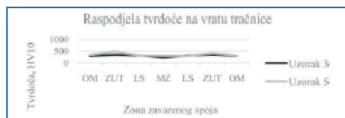
Slika 19. Dijagram vrijednosti tvrdoće po zonama zavara vrata tračnice
