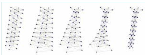
Slika 3: Primjeri različitih inicijalnih geometrija prostorne rešetkaste konstrukcije dobiveni za različite vrijednosti parametra uvedenih za parametrizaciju geometrijskih karakteristika konstrukcije. Parametrima za topološku manipulaciju konstrukcije se kontrolira prisutnost dijagonalnih konstrukcijskih elemenata.
