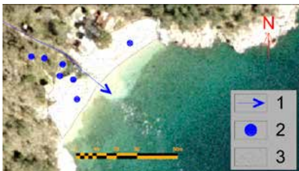
Slika 2: Žalo Uboka južno od Mošćeničke Drage: 1.trasa bujičnog vodotoka; 2. povremeni izvori
