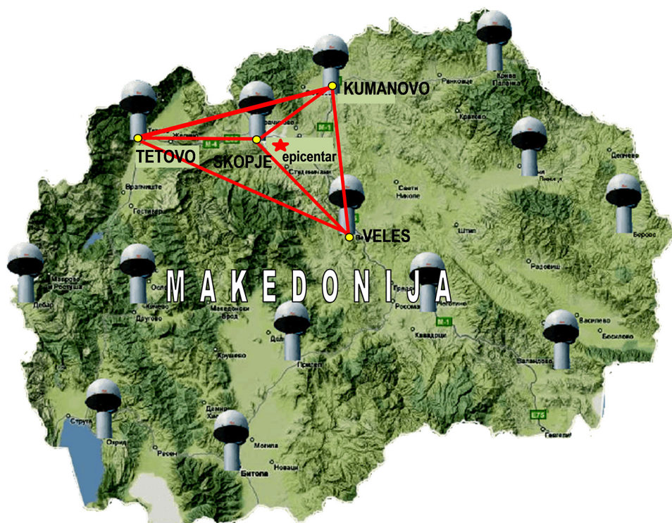
Slika 1. Permanentne referentne GNSS-postaje u MAKPOS-ovoj pozicijskoj mreži u Makedoniji i mreža za ispitivanje deformacija Zemljine kore prije i nakon potresa u Skopju 2016. godine (Dimeski i dr. 2012, Trpeski i dr. 2013).
