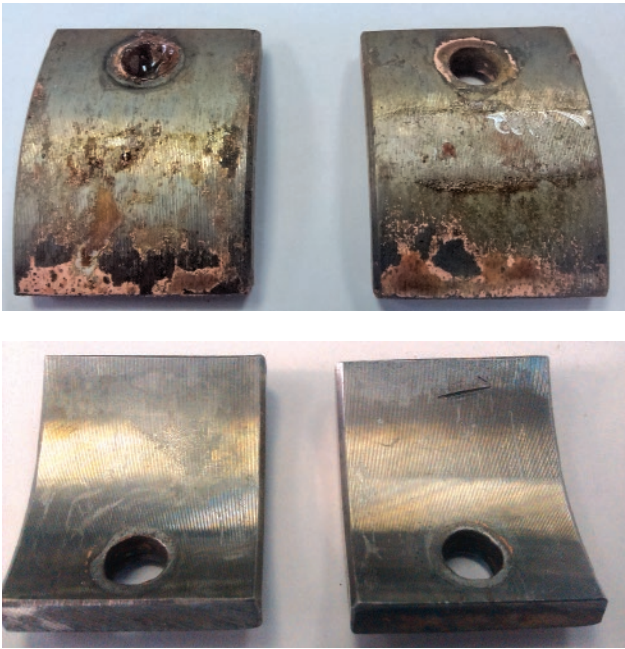
Slika 11. Izgled kupona koji su zbog utvrđivanja postojanosti filma inhibitora, nakon 3 dana ispitivanja u slojnoj vodi bili uronjeni u otopinu bakar-sulfata (gore). Izgled kupona nakon 3 dana ispitivanja u sustavu slojne vode polja Ivanić, uz prethodno izlaganje kupona 40% šarži inhibitora korozije (dolje).
