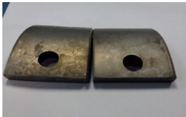
Slika 6. Izgled kupona nakon 3 dana ispitivanja u sustavu slojne vode polja Ivanić, bez prethodnog izlaganja kupona šarži inhibitora korozije. (Slijepa proba, stakleni reaktori)
