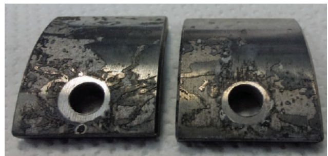
Slika 10. Izgled kupona nakon 3 dana ispitivanja u sustavu slojne vode polja Ivanić, bez prethodnog izlaganja kupona šarži inhibitora korozije (Autoklav, Ispitivanje 1.)
