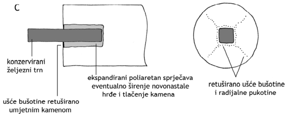
Crtež 3. Shematski prikaz sanacije korodiranih željeznih trnova
