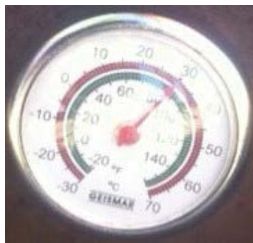
Slika 14. Magnetni toplomjer za mjerenje temperature tračnice
