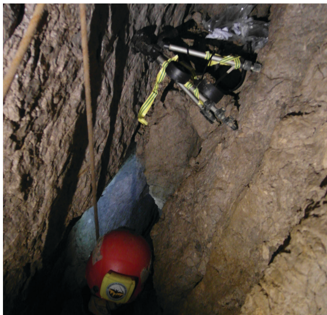
Sl. 20. Anemometar postavljan na suženju iza ulazne dvorane u jami Sireni. Foto: Dalibor Paar, 2013.
