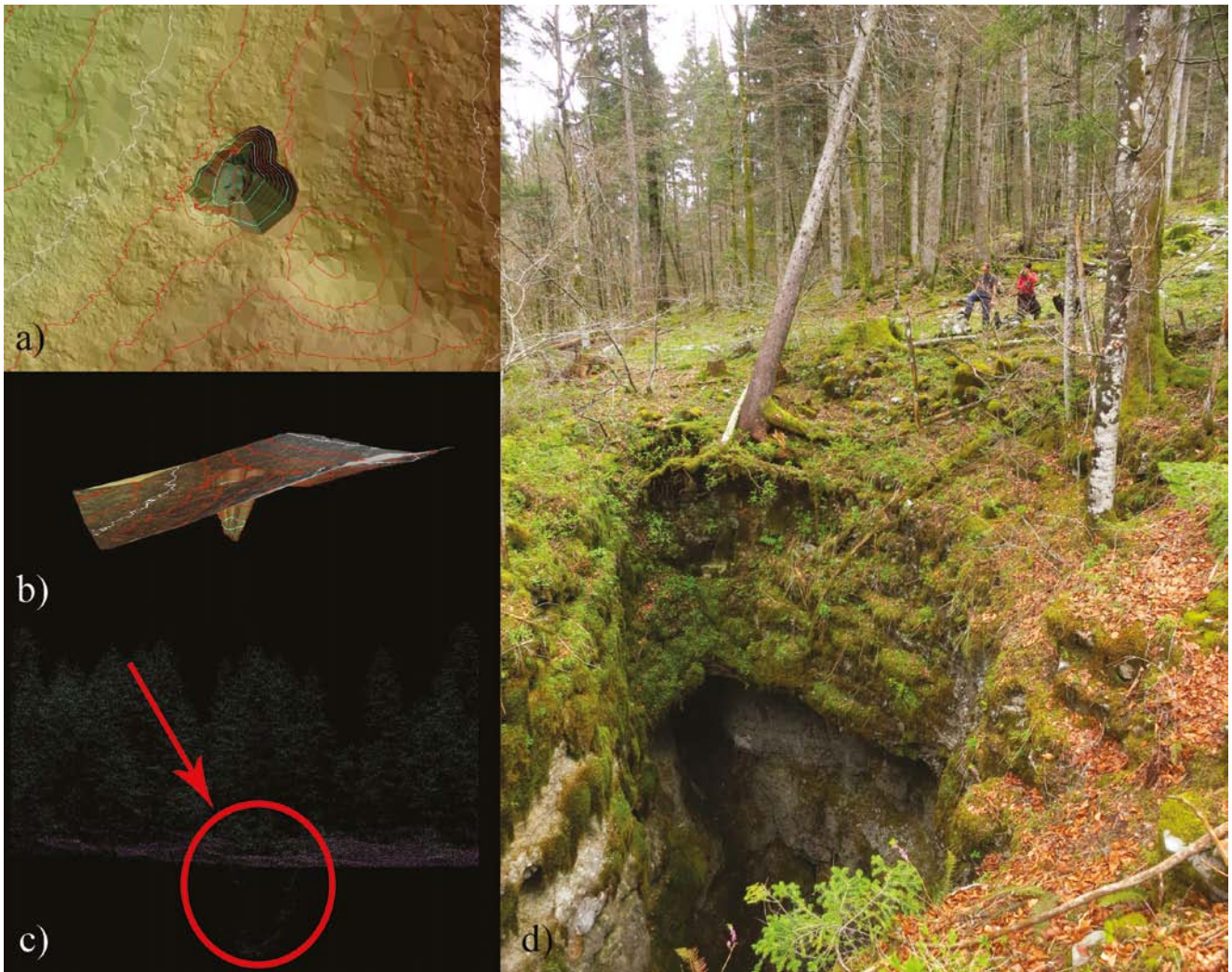
Primjer srednje velikog do velikog vertikalnog ulaza u speleološki objekt (Jamica u Praprotnoj dragi, ulaz 13 x 15 m), izrađeno uz pomoć preglednika FugroViewer: a) 2D prikaz terena pomoću nepravilne mreže trokuta, b) 3D prikaz terena pomoću nepravilne mreže trokuta, c) presjek klasificiranog oblaka točaka, d) fotografija ulaza, foto: L.Kukuljan, izvor podataka eVode: LIDAR 2017.
