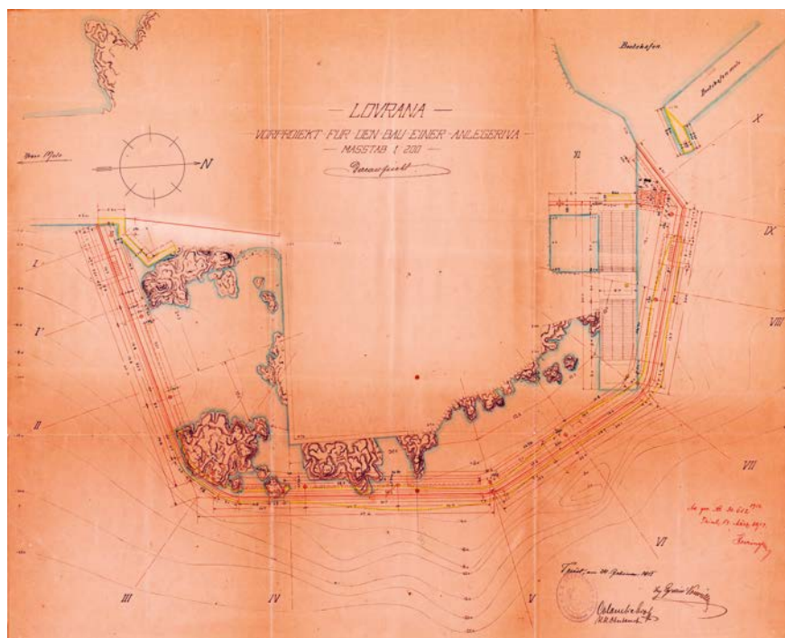
Slika 9. Plan izgradnje istočne operative obale iz 1913. godine (HR-DARI-46, spisi Vorprojekt für den Bau einer Landungriva in Lovrana )
