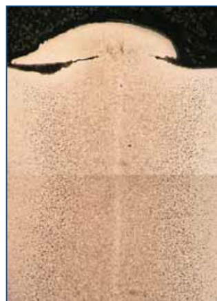
Slika 4. Mikrostrukturni prikaz elektrootpomno zavarenog spoja Figure 4. Microstructural view of ERW weld joint
