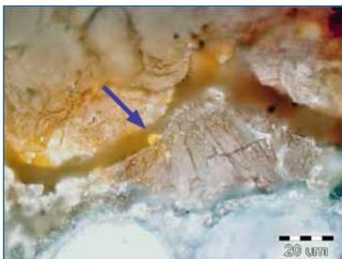
Slika 5. Istaložene čestice bakra na površini pocinčanih cijevi Figure 5. Metallic copper deposited on the surface of galvanized pipes
