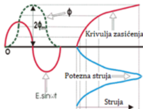
Slika 2 Prikaz povećanja toka i potezne struje (inrush current) za ostvarivanje zasićenja višeg od nazivnog. [2]
