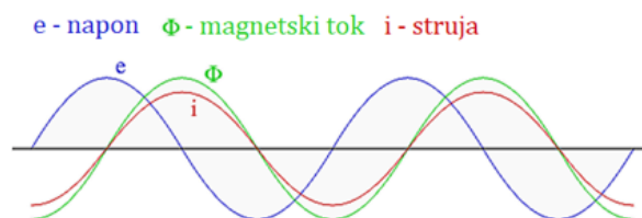
Slika 1 Trajno radno stanje: Magnetski tok i struja zaostaju za naponom za 90^\circ el. [1]
