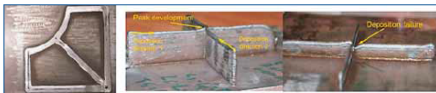
Slika 4. Šupljine (a), višak materijala (b) i nedovoljno taloženje (c) [1], [8]
