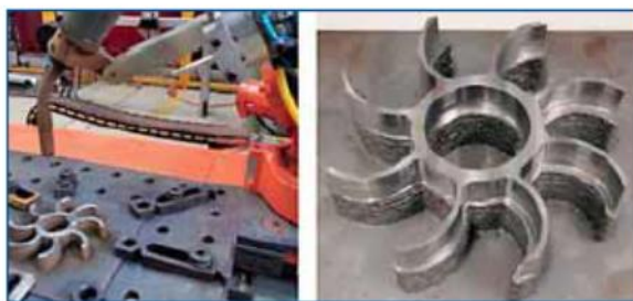
Slika 2. Izrada WAAM komada (lijevo) i djelomično strojno obrađeni isti komad (desno) [4]
