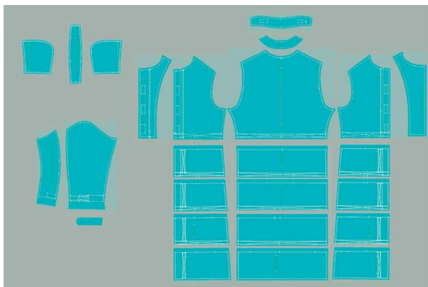
Sl.2 Prikaz modeliranih krojnih dijelova osnovne tkanine vanjske školjke modela nautičarske vjetrovke primjenom CAD sustava Lectra Systemes i programskog paketa Modaris
