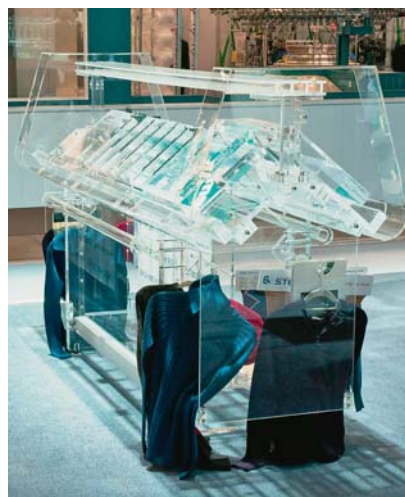
Sl.2 Stroj za pletenje s prozirnim okvirom za demonstraciju rada i uvid u strukturu stroja s ugrađenim dijelovima tvrtke Groz-Beckert
