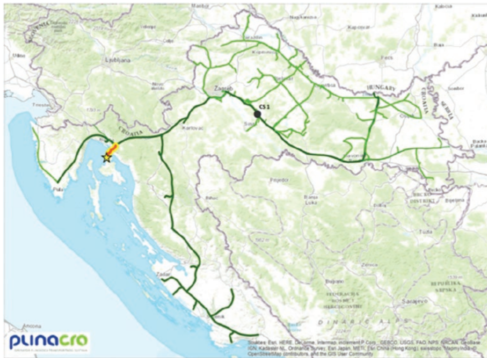
Slika 1. Postojeći transportni sustav Plinacra, lokacija LNG terminala (zvjezdica) i plinovoda Zlobin–Omišalj (crvena linija)
