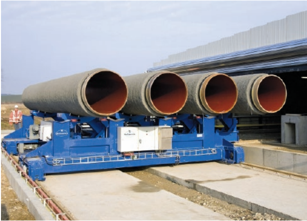
Slika 2. Betonom obložene čelične cijevi (na slici su cijevi DN1200 za podmorski plinovod Nord Stream 1, slične će se koristiti za plinovod Zlobin-Omišalj)
