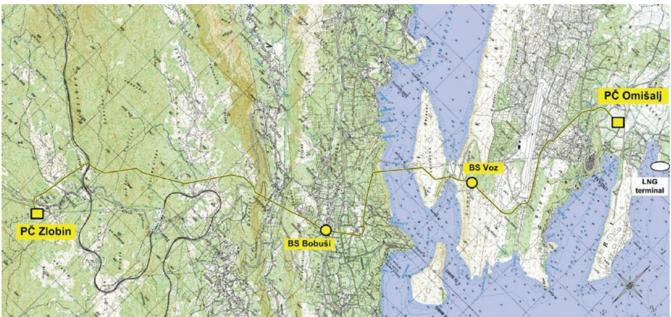
Slika 3. Trasa plinovoda Zlobin-Omišalj s nadzemnim objektima plinovoda
