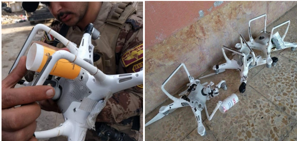
Slika 3. Primjeri komercijalno dostupnih BL tvrtke DJI prerađenih od strane pripadnika ISIL-a da služe kao pokretni nosači i izbacivači ručnih bombi i granata (MEMRI TV)
