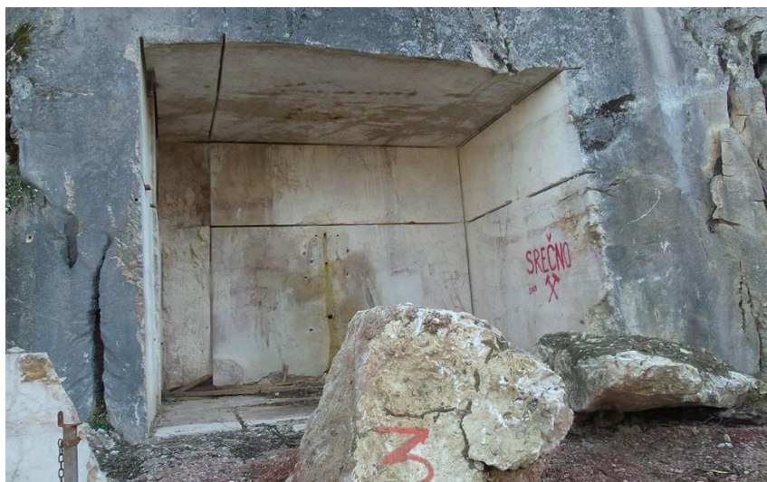
Slika 7. Istražna galerija urađena u prvom produktivnom sloju (foto Hajdarević, 2017)
