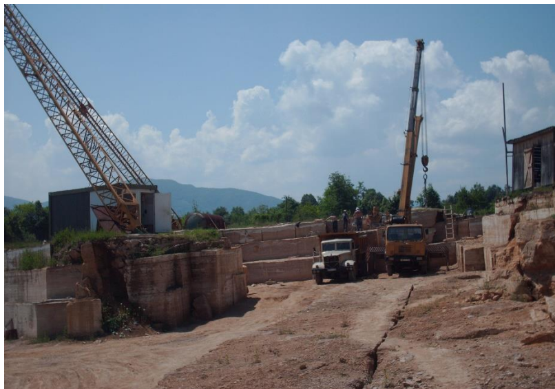
Slika 5. Utovar blokova Plivita na kamion na ležištu Divičani (foto Hajdarević, 2007)
