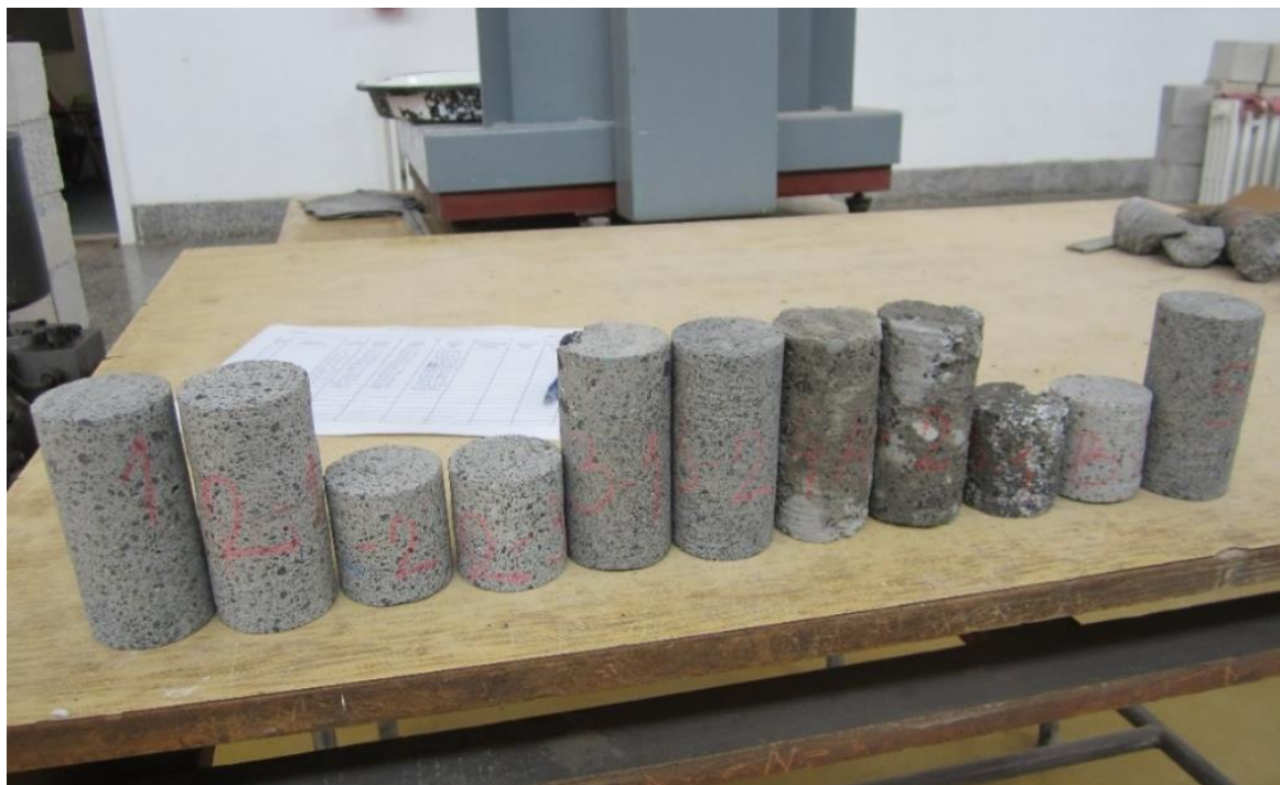
Slika 1: Uzorci za ispitivanje monoaksijalne čvrstoće očvrslе troske
