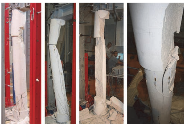
Slika 7. Uzorci K1, K2, K3 i K6 nakon sloma
