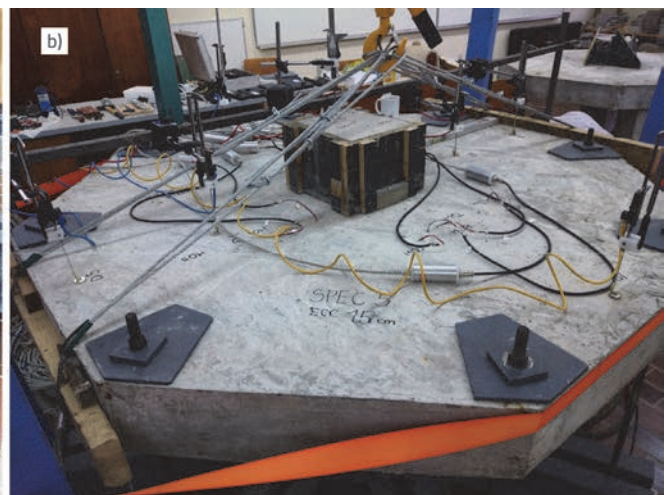
Slika 9. Postavljanje eksperimenta: a) Čelični oslonac i kutijasti okvir s hidrauličnim prešama; b) Uzorak pripremljen za ispitivanje
