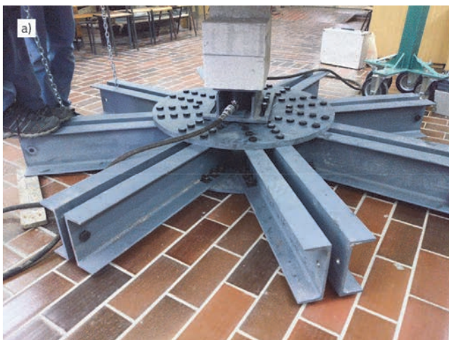
Slika 9. Postavljanje eksperimenta: a) Čelični oslonac i kutijasti okvir s hidrauličnim prešama; b) Uzorak pripremljen za ispitivanje
