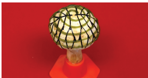
Slika 1 – Bijeli šampinjon sa spiralno nanesenim cijanobakterijama u alginatnoj pasti na mreži vodljive tinte od grafena i PEDOT:PPS-a 2
