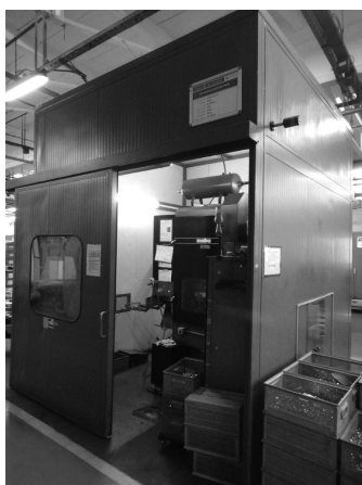
Slika 1. Oklapanje i izoliranje izvora buke
