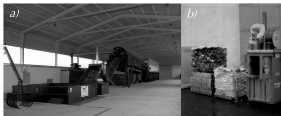
Slika 4. Primjeri linije za sortiranje papira i kartona (a) i baliranje ambalaže (b)
