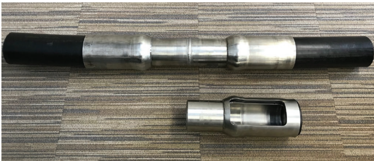
Slika 2. Primjer fleksibilne cijevi sa spojnicama
