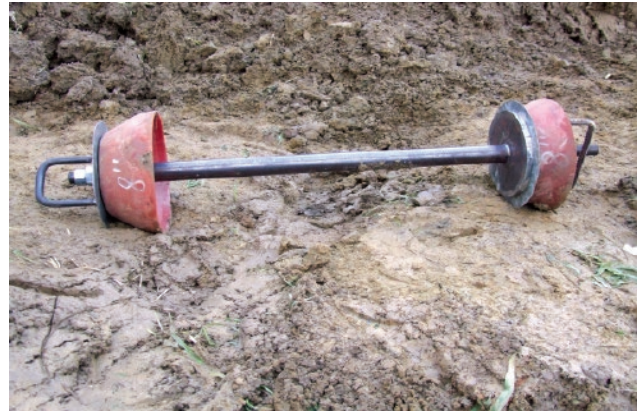
Slika 3. Čistač sa kalibracijskom pločom
