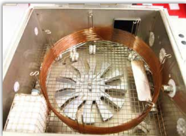
Slika 2. Kapilarna kolona za plinsku kromatografiju
