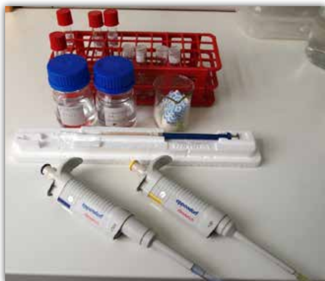
Slika 6. Reagensi i pribor za nanošenje uzorka na kolonu plinskog kromatografa
