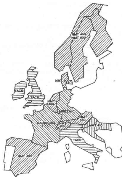
Slika 2. Rasprostranjenost pojedinih mreža za mobilnu telefoniju u Europi Figure 2. Dispersion of mobile networks in Europe
