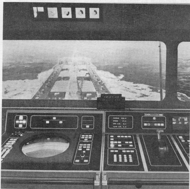
Slika 2. Navigacijski simulator postavljen na Pomorskom fakultetu u Dubrovniku kojim je moguće oponašati stvarne uvjete manevriranja, navigacije i izbjegavanja sudara različitim vrstama brodova.
