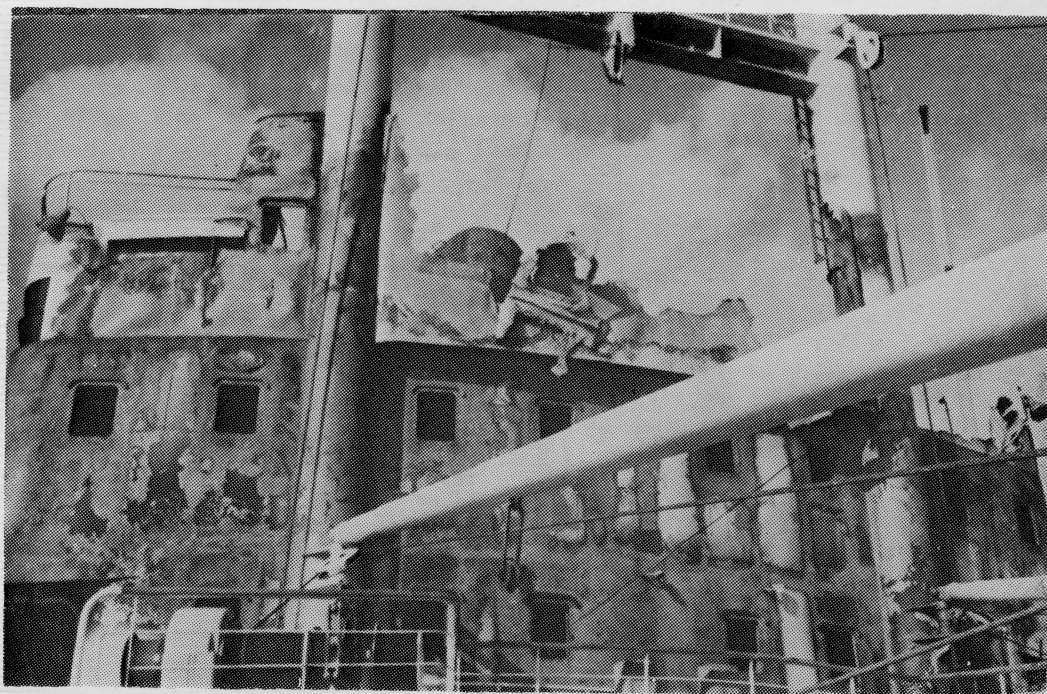
Ostatak nadgrađa poslije požara na jednom našem brodu. Dio komandnog mosta na desnoj strani (slike) potpuno rastaljen vatrom.
