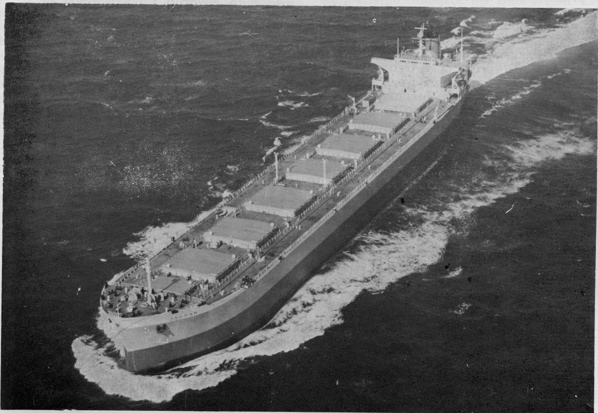
M/b »JADRAN« »Atlantske plovidbe« iz Dubrovnika nosivosti 72.150 tona, motor DOXFORD 76J8 snage 20000 KS; brzine 15,75 č. Dimenzije: dužina 228,10 m; širina 32,23 m; visina 19,20 m; gaz 14 m. Brod je suvremeno opremljen, a spomenimo samo protusudarni radarski uređaj, uređaj za satelitsku navigaciju i brodski teleprinterski uređaj.
