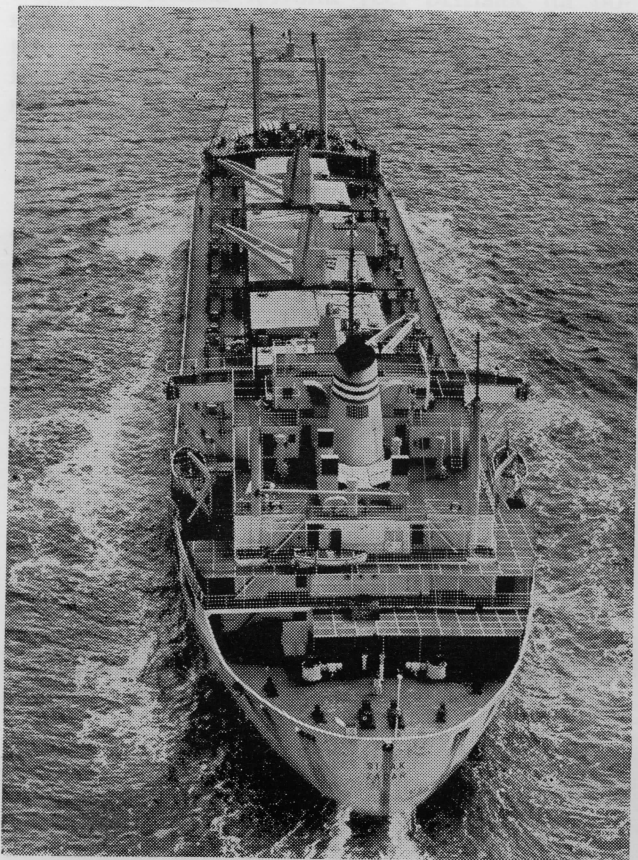
Bulkcarrier »Sisak« (Jugotanker) nosivosti 41.150 tona, izgrađen u Splitu 1967. godine
