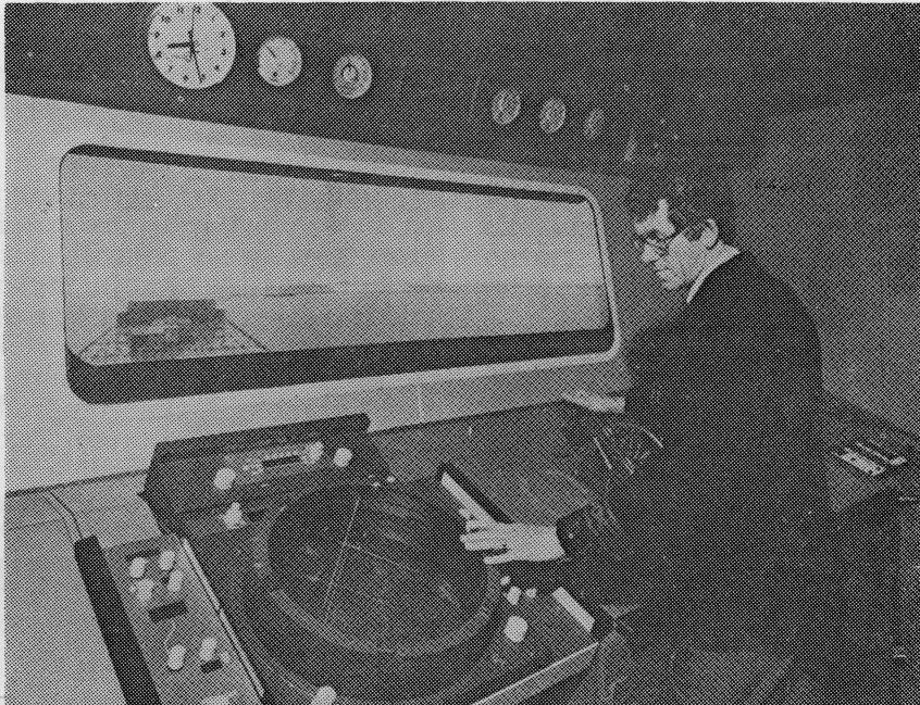
Simulator za rukovanje i manevriranje brodom: na »zapovjedničkom mostu« simulirana situacija je realistička sa svim elementima koji se u plovidbi susreću
