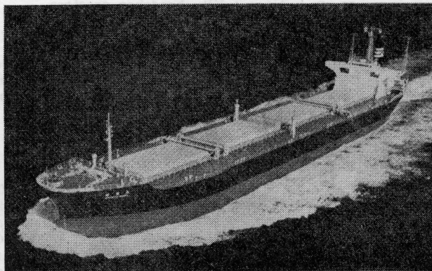
»Descartes« — brod za prijevoz 50.000 m 3 ukapljenog metana najveća jedinica svoje klase u svijetu
