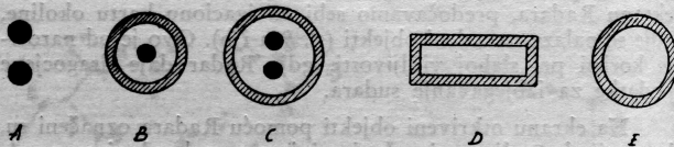
Slika 11 — visokofrekventni talasovodi u presjeku, A) dvožični vod, B) koaksijalni kabel, C) dvoprovodni koaksijalni kabel, D) pravokutni talasovod, E) okrugli talasovod
