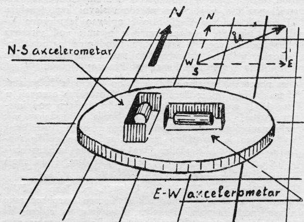
Svaka od ovih komponenata može se odvojeno integrirati i prikazati u obliku prevaljenog puta prema Sjeveru, Jugu, Zapadu ili Istoku. Zbog sile zemljine gravitacije očigledno je da sprava za mjerjenje ubrzanja (akcelerometar) mora da bude smještena uvijek horizontalno, to jest pod pravim kutem na zamišljenu vertikalnu os prema centru zemlje za koju se u navigaciji pretpostavlja da je kugla.
