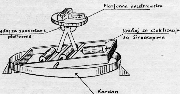
u posljednje vrijeme tehnički mnogo savršenije izvedenog što je to bilo ranije. Da bi se izbjegao uticaj nesimetričnog trenja u ležajima, zatim uticaj sile gravitacije i poremećenja kardanskog sistema rotori žiroskopa stavljeni su u nepropusne cilindre napunjene uljem. Sam cilindar
