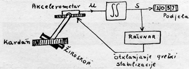
ubrzanja i prenosi ih električnim putem u elektronski integrator, a ovaj određuje prevaljeni put. Pored toga, vrijednost prevaljenog puta ide još u poseban računar, koji služi za otklanjanje greški u stabilizaciji platforme akcelerometra.
