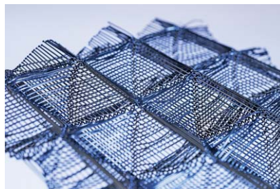
Sl.3 Tehnička tkanina obrađena sustavom Monforts ITT
