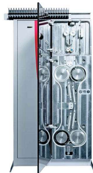
Sl.2 Prikaz sustava za mjerenje prekidnog istezanja unutar uređaja USTER® TENSOJET 5
