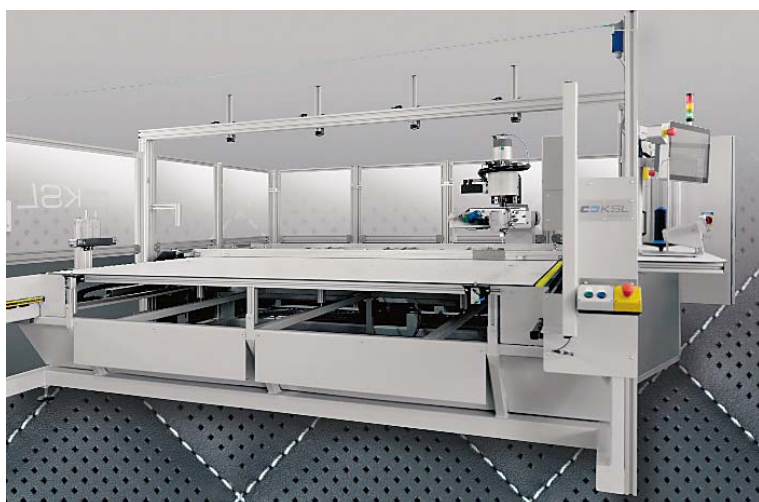
Sl.1 CNC šivaći stroj KL 110 tvrtke Pfaff s inteligentnim sustavom VISION SYSTEM
