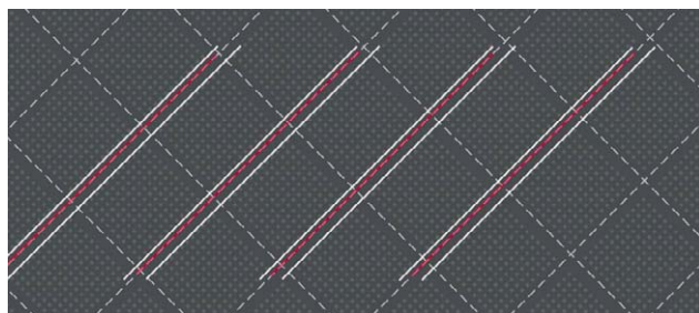
Sl.2 Bez sustava VISION SYSTEM šavovi se mogu nalaziti izvan područja tolerancije
