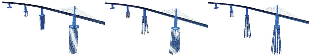
Slika 15. U fazi traženja optimalnog načina temeljenja bile su analizirane brojne varijante sa različitim brojem pilota, i s kosim pilotima
