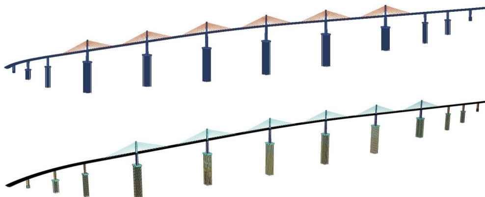
Slika 24. RM Bridge / Bentley model sa štapnim (beam) elementima i Sofistik model sa štapnim i pločastim elementima
