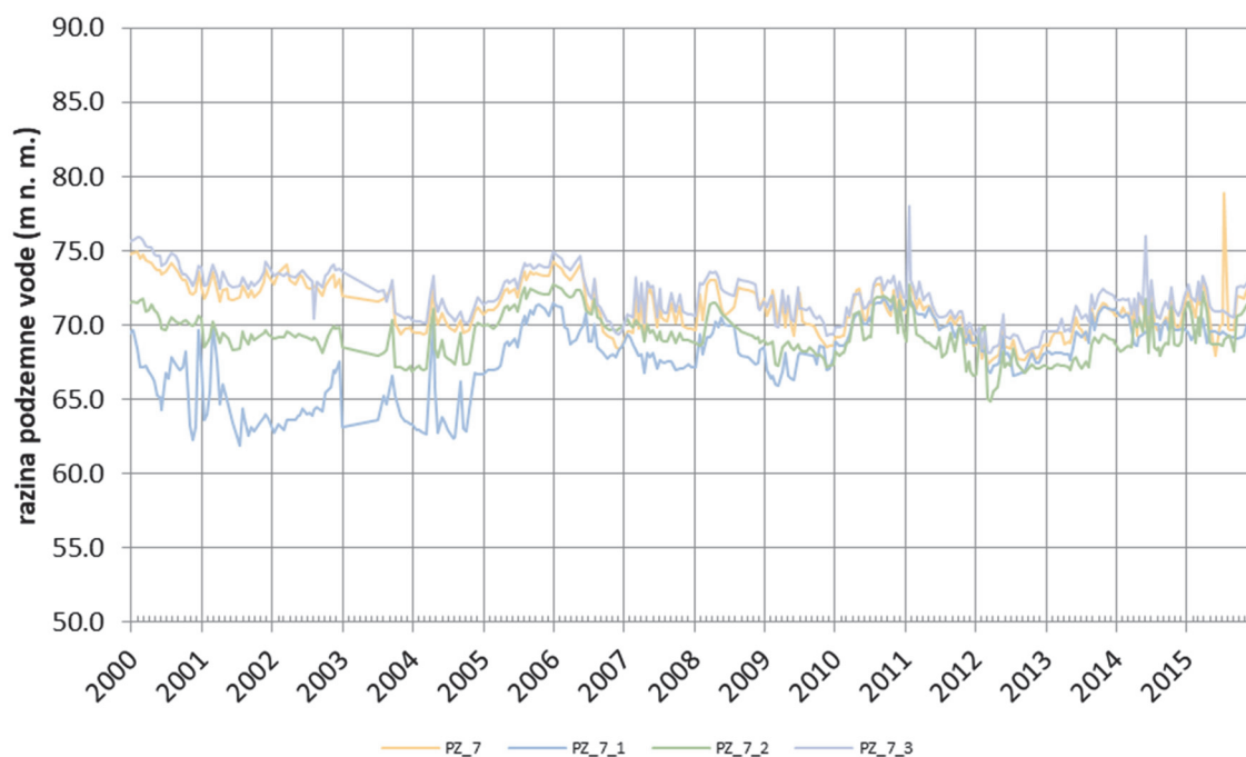
Slika 8. Kolebanje razine podzemne vode po profilu vodonosnika na lokaciji piezometarskoga gnijezda PZ-7 smještenog pokraj zdenaca Z-7.
