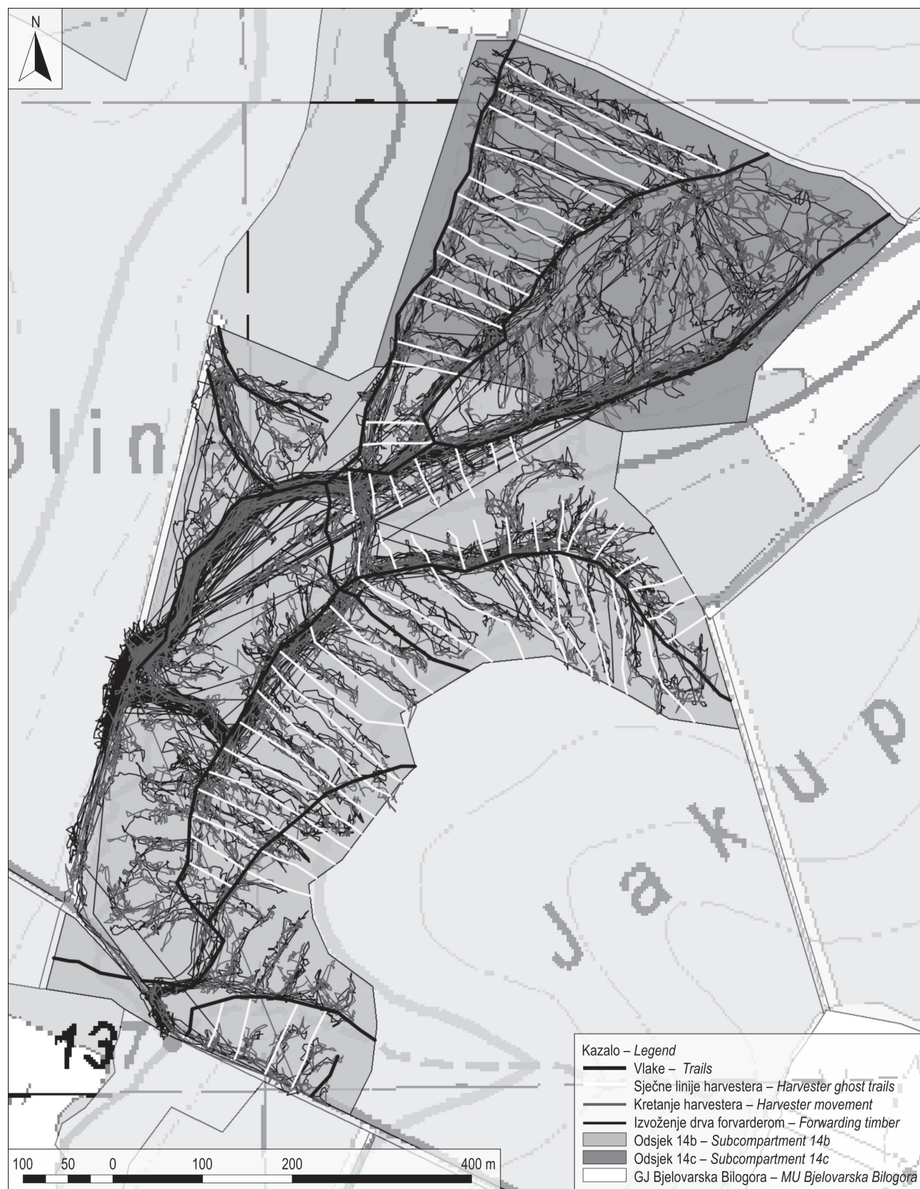
Slika 4. Karta gaženja tla nakon obavljene sječe i izrade te nakon izvoženja drva Fig. 4 Soil disturbance after machine felling and timber forwarding
