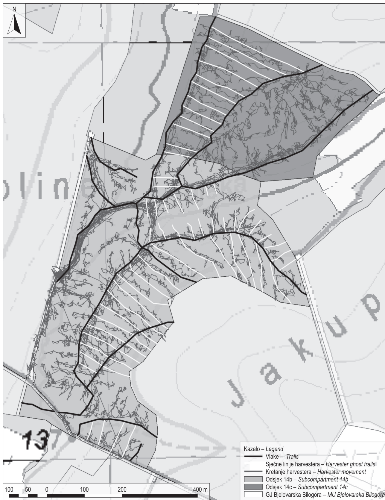
Slika 2. Karta gaženja tla nakon obavljene strojne sječe i izrade harvesterom Fig. 2 Soil disturbance after harvester felling and cutting
