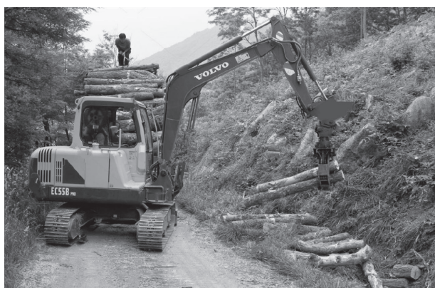
Fig. 4 Wood grab on a forest road (source: www.alamy.com) Slika 4. Utovarivač s hvatalom na šumskoj cesti (izvor: www.alamy.com)
