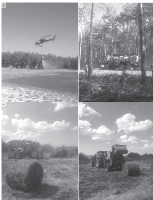
Slika 2. a) Demonstracija gašenja šumskoga požara helikopterom; b) izvoženje celuloznoga drva forvarderom; c) pridobivane biomase za energiju biobalerom
