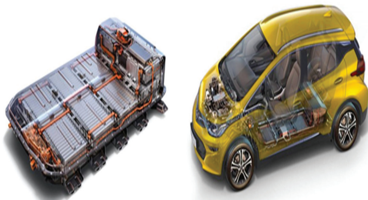
Slika 3. Smještaj baterija u električnom automobilu Figure 3. Battery position in an electric car
