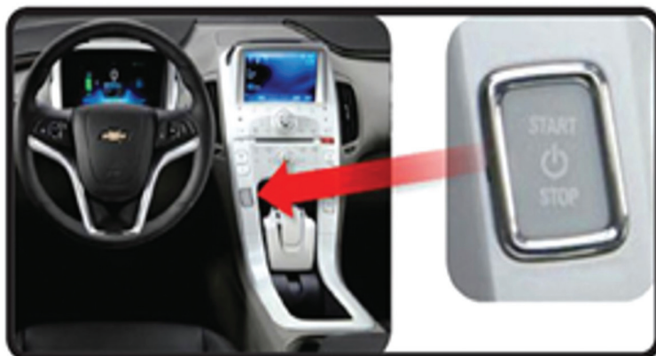
Slika 7. Dugme za “paljenje” i “gašenje” električnog automobila Figure 7. The electric car ignition switch
