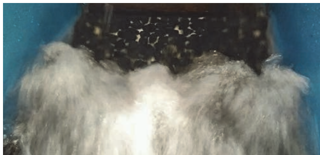
Slika 5. Stvarna fotografija vodnog skoka
