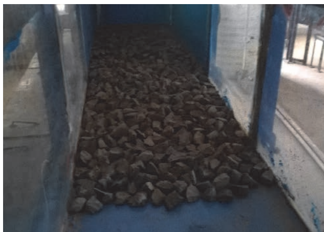
Slika 3. Fotografija drobljenog agregata zalijepljenog na dno žlijeba kako bi se dobilo hrapavo korito
