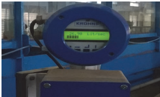
Slika 6. Fotografija elektromagnetskog mjerača protoka koji je korišten u eksperimentima
