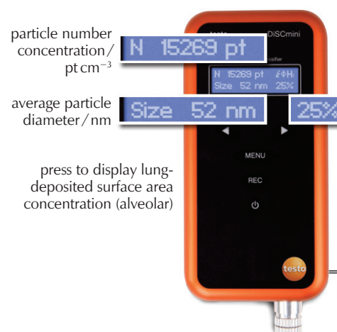
Slika 2 – Instrument za mjerenje broja i veličine nanočestica (izvor: www.testo-particle.com )
