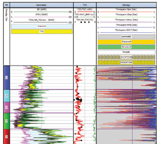
Slika 23. Detalj slike 22. Uran (plavo osjenjeno) jedan od jako važnih pokazatelja količine prisutne organske tvari u stijeni (koeficijent korelacije je 0,86), ali nije bezuvjetno jednoznačan, te može dovesti do pogrešnih zaključaka (žuto osjenjeno). Bušotina je iznimni primjer in situ sistema kod kojega se proizvedeni CH akumuliraju u obližnjim rezervoarima, sitno do srednje zrnatim pješčenjacima (FM 2, 3, 4 i 5) dok je glavna akumulacije CH u FM 1, čiji među lapori su također matična stijena. Vertikalni raspon bušotine je oko 800 m.
