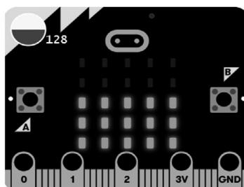
Napravit ćemo mjerač svjetlosti. Led lampice iskoristit ćemo kao senzor svjetlosti. Izmjerit ćemo količinu svjetlosti koja dolazi na *micro:bit* i prikazati je pomoću led lampica. Kako bi mjerač svjetlosti stalno prikazivao trenutno stanje na *micro:bit* računalu, potreбно je dovući *forever* petlju iz *Basic* katego-
