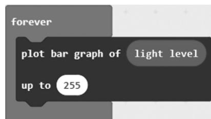
Sad se na simulatoru prikazuje gotov program koji moramo prebaciti na *micro:bit*. Nakon što ga prebacite, potrebno ga je testirati. Rezultati bi trebali biti da u potpunom mraku svijetli samo jedna lampica, dok bi pod svjetiljkom trebale svijetliti sve lampice.
