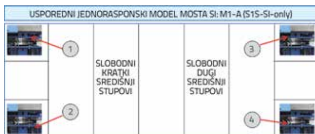
Slika 17. Položaji uređaja DSRSB na analiziranom uobičajenom seizmički izoliranom (C-SI) prototipskom modelu jednorasponskog mosta M1-A (samo M1S-SI)
