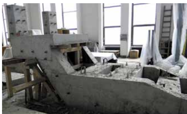
Slika 9. Betonirani lijevi segment donjeg ustroja oblikovanoga prototipskog modela mosta sa sustavom USI-SF
