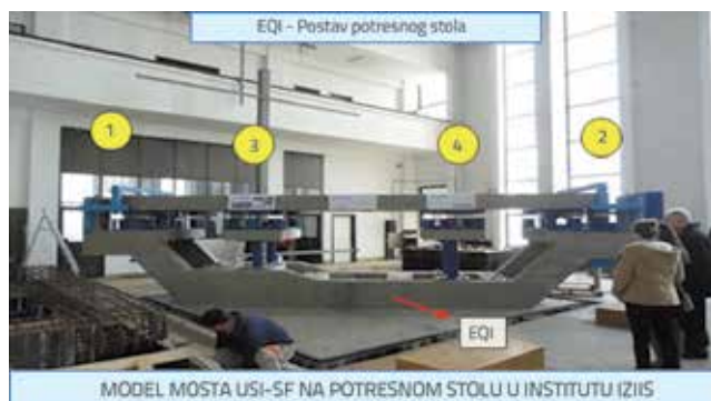
Slika 10. Prototipski model mosta u velikom mjerilu sa sustavom USI-SF koji je korišten za ispitivanja na potresnom stolu radi simuliranja djelovanja jakog potresa: (1) krajnji lijevi oslonac; (2) krajnji desni oslonac; (3) oslonac iznad kraćih središnjih stupova; (4) oslonac iznad dužih središnjih stupova
